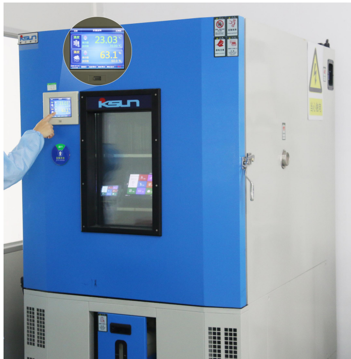
图 4-7 高低温老化测试图
